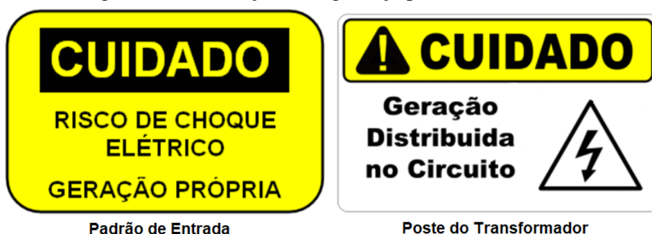
Figura 8 – Sinalização de segurança para o sistema fotovoltaico.
