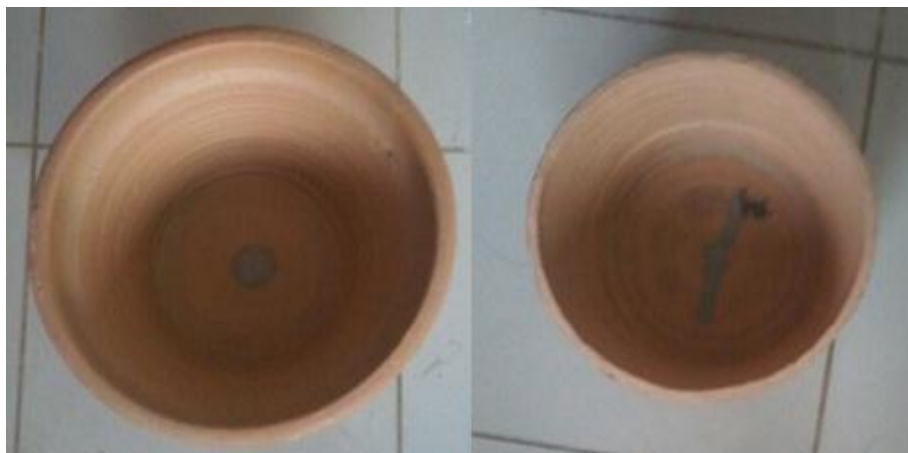
Figura 2 - Preenchimento do fundo dos vasos com cola epóx Fonte: Autores, 2016
