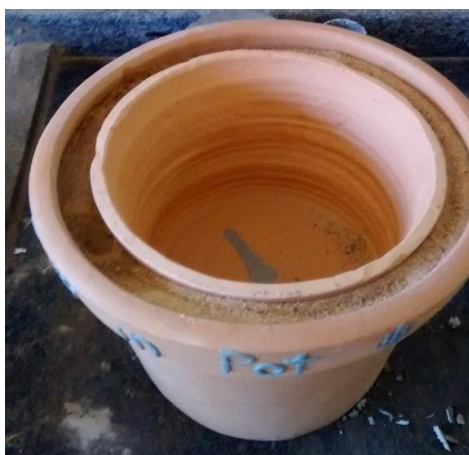
Figura 3 - Adição de areia entre os potes Fonte: Autores, 2016
