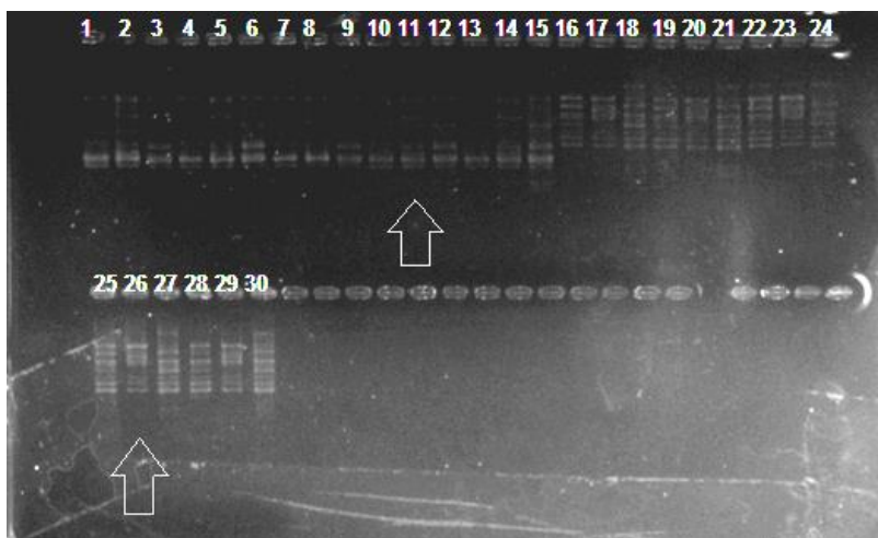
Figura 2. Visualização em gel de agarose 1,7% do DNA das plantas de Cereus sp. amplificadas com os primers ISSR-1 (amostras 1 a 15) e ISSR-4 (amostras 16 a 30), com diferentes concentrações de MgCl_2 : 2,0 mM (amostras 1-3; 15-18); 2,5 mM (amostras 4-6; 19-21); 2,7 mM (amostras 7-9; 22-24); 3,0 mM (10-12; 25-27) e 3,2 mM (amostras 13-15; 28-30). As setas indicam a concentração de MgCl_2 mais adequada e selecionada (3,0 mM) para amplificar o DNA das plantas do Paraná e do Piauí.
